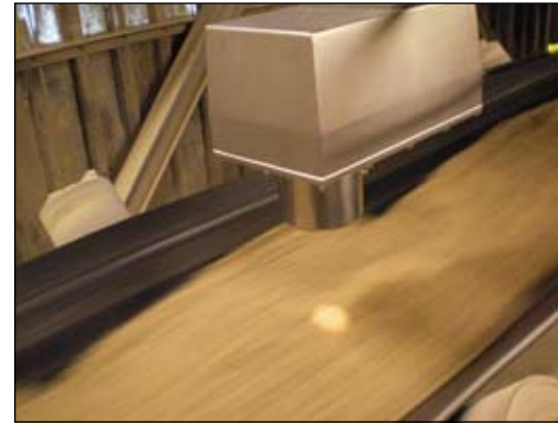
Het CM710e vochtmeetsysteem van Quality2Process, gemonteerd aan de ingang van de droger
