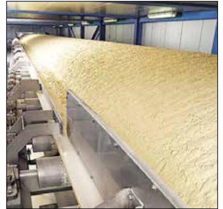
Transport over de vochtverdeelband; naast aardappelvlokken produceert Rixona in Venray ook aardappelgranulaat
