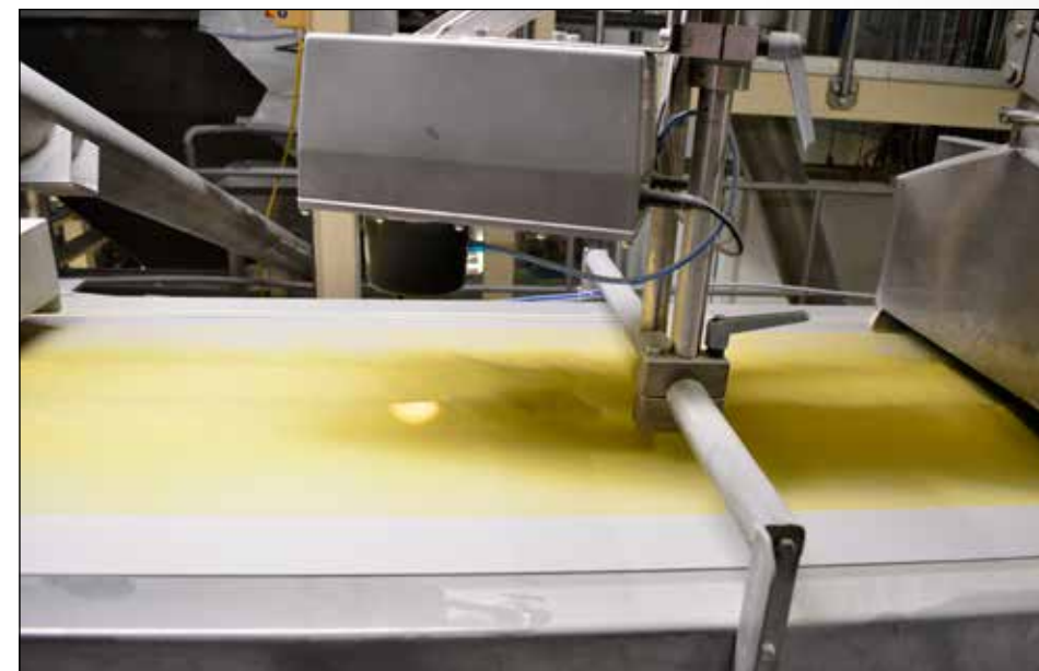
De hoogwaardige vochtmeters van Quality2Process meten continu het percentage vocht; de operator kan indien nodig onmiddellijk bijstellen, waardoor productieverlies wordt geminimaliseerd
