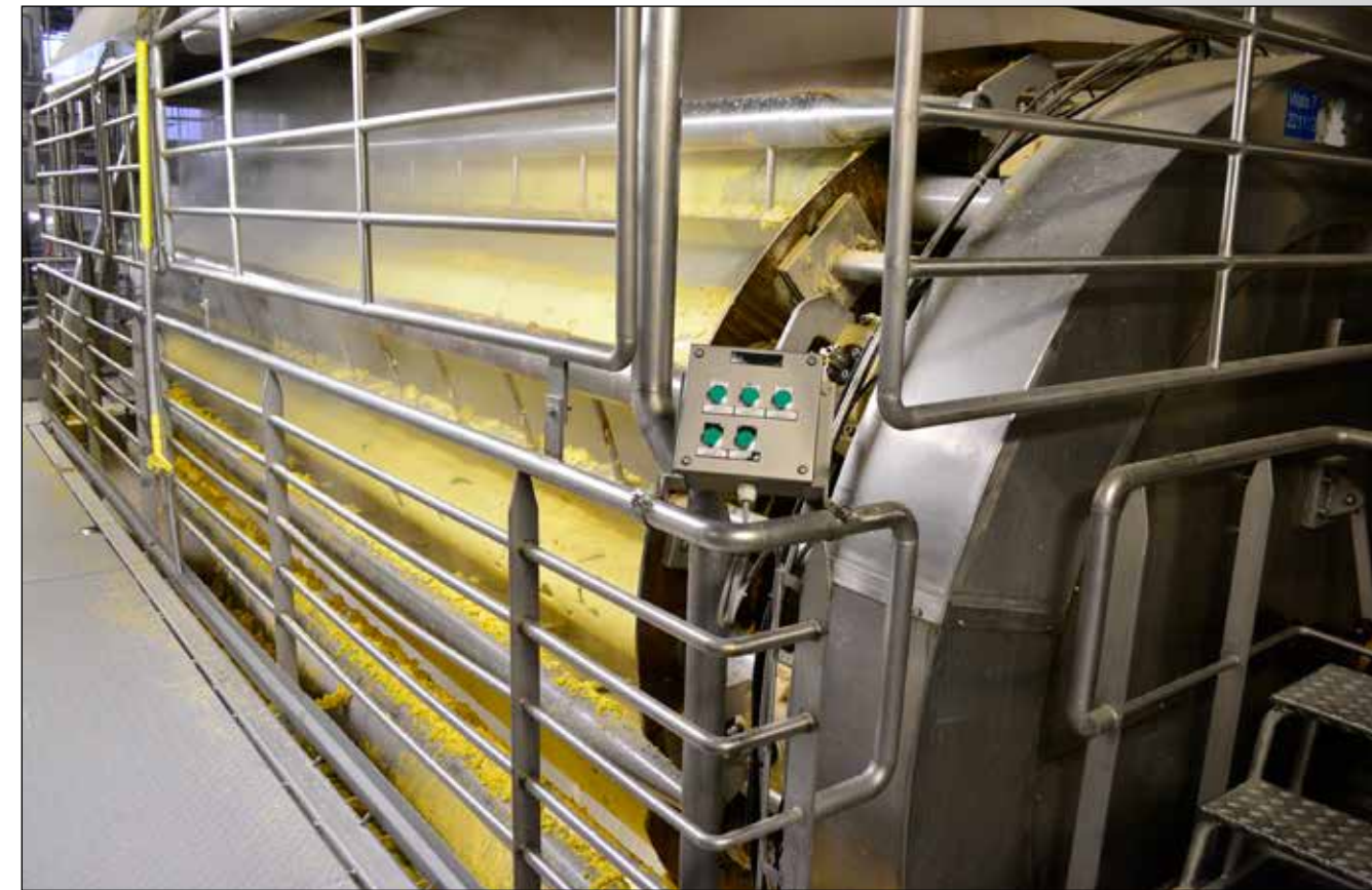
Een wals met zeven rollen, het hart van het productieproces voor aardappelvlokken, krijgt stoom geïnjecteerd van 170°C
