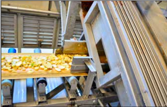
Na het wasproces snijdt de machine de aardappelen in plakken van 15 millimeter dikte
