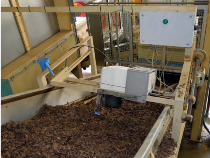
Afb. 2 Een NDC TM710e online Nabij Infrarood vochtmeter van Quality2Process boven een bandtransporteur
