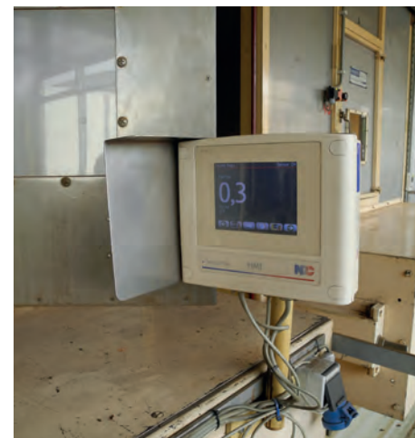
Afb. 4 Een NDC TM710e online vochtmeter van Quality2Process meet het actuele vochtgehalte van de final blend van het sigaren binnengoed
